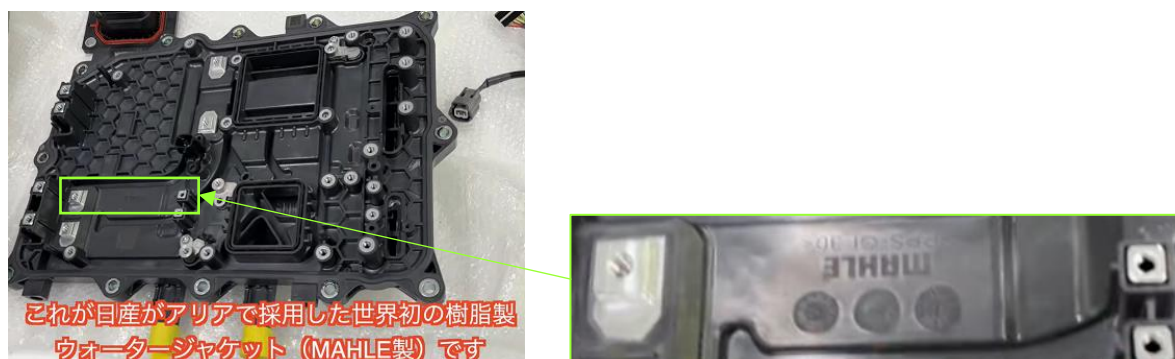
図 45 樹脂製インバータウォータージャケット 109
