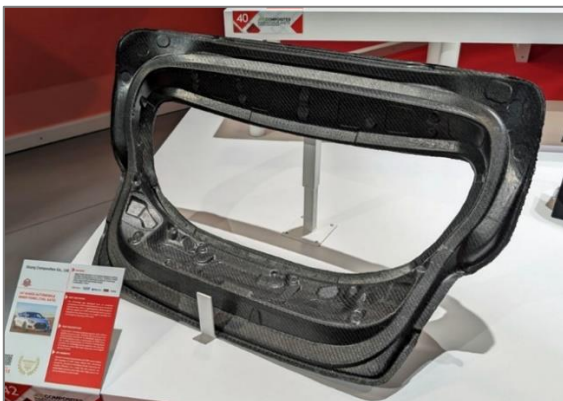
写真 8 rCF を使うテールゲート内パネル 写真 9 現代自動車ヴェロスター (Ilsung Composites)
