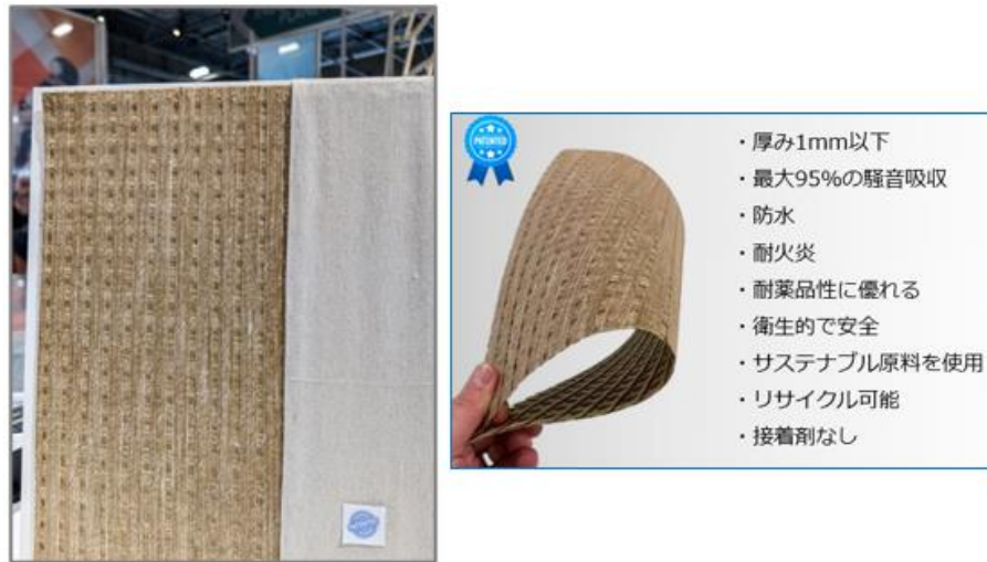
写真 15 騒音吸収性能を持つ薄肉織物
