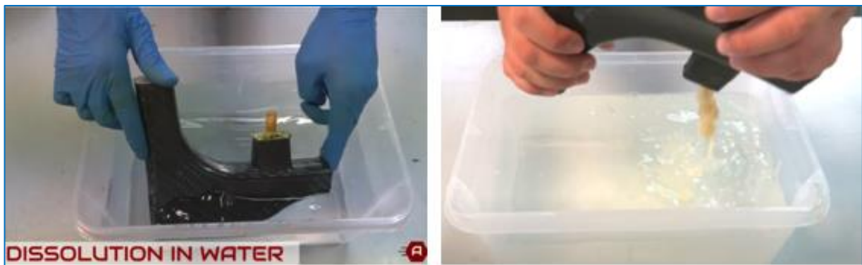
写真 18 CFRP 中のマンドレルは水中で溶解する。
