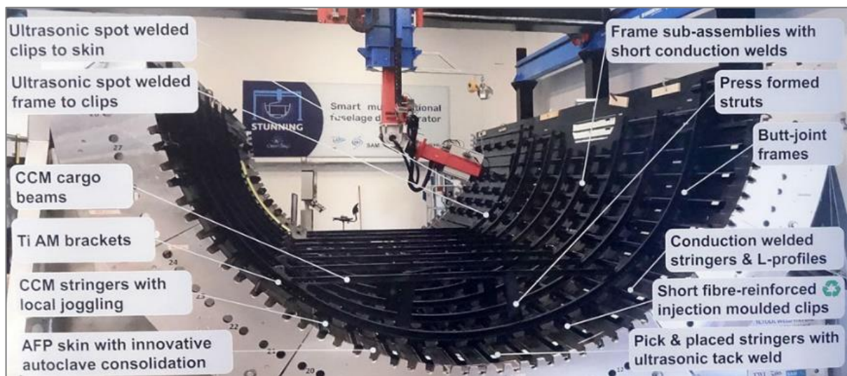
写真2 胴体パネルの構成部品と接合技術(展示パネル)
