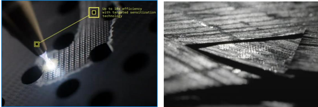
写真 10 大気圧低温プラズマで樹脂を分解し、炭素繊維をチップとして使う (Fairmat 動画)
