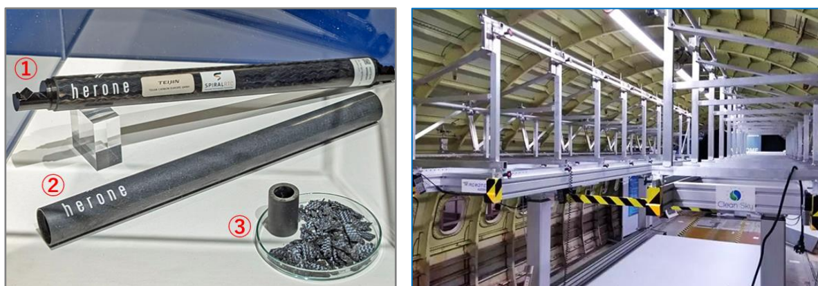
写真3 左:航空機端材を再生利用したロッド(展示) 右:航空機天井の金属製モジュール(Clean Sky)
