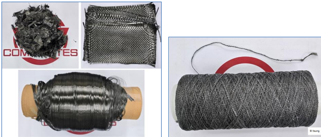
写真 7 電磁導で処理した CFRP と、それを紡糸した連続繊維 (Ilsung Composites)
