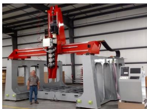
②工場内に施工中の LASAM
