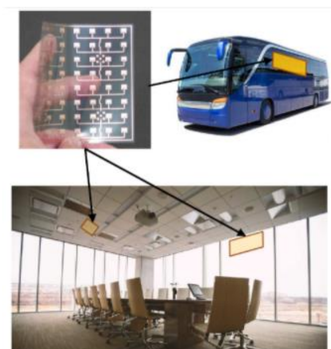
図 2-3-11 東レの高透明 PPS フィルムアンテナをバスや室内に設置する構想 ( https://xtech.nikkei.com/atcl/nxt/news/18/11686/ )
