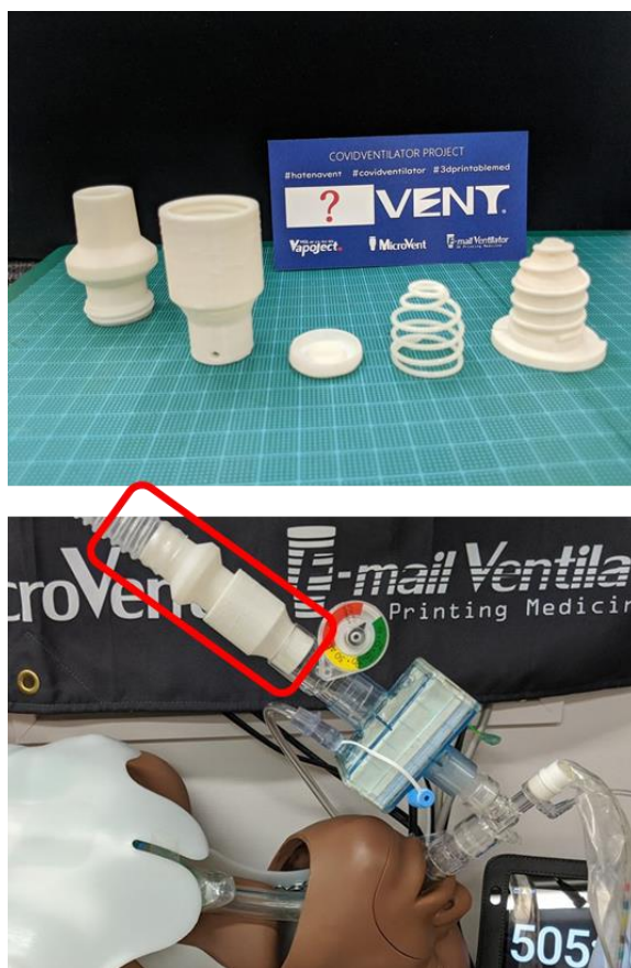
図9-16 3Dプリンタで作成された超簡便型人工呼吸器のパーツ（上）と組上げ後の装着図（下 赤枠） https://www.businessinsider.jp/post-211344
